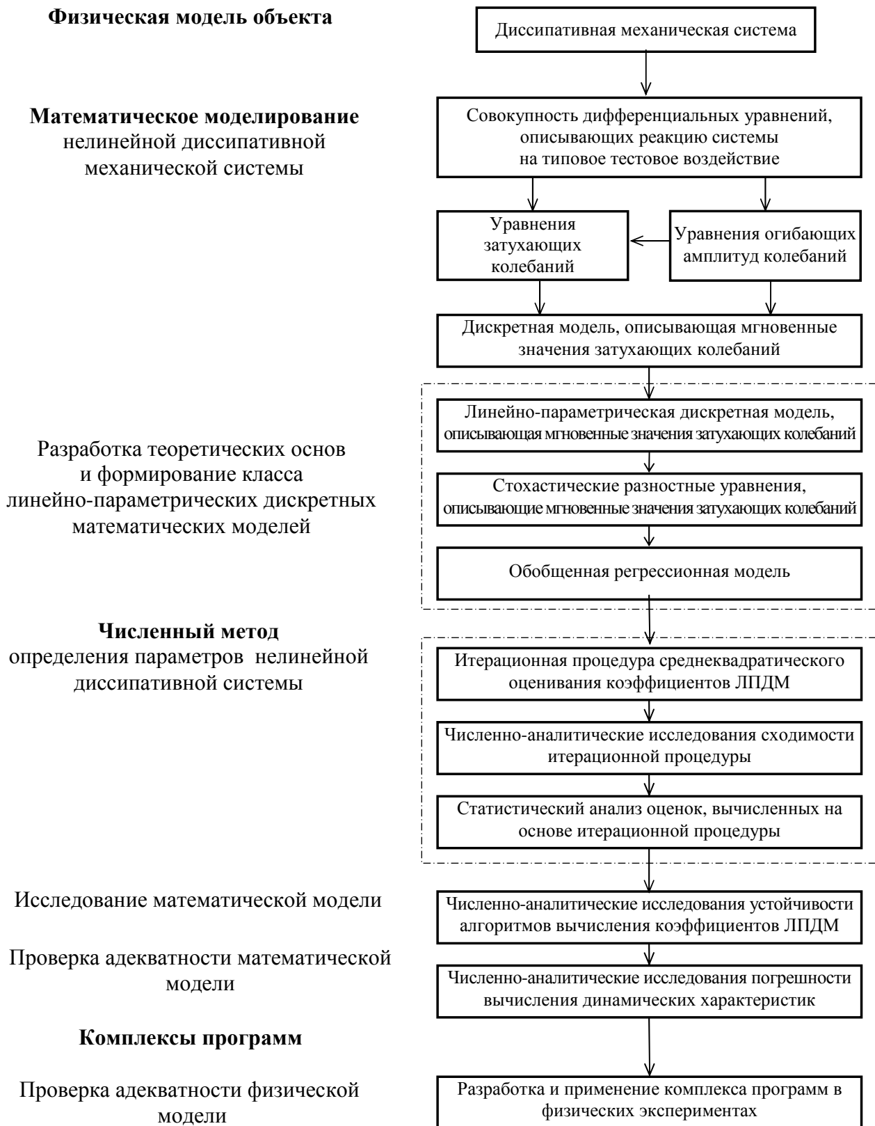
Рисунок 1 – Схема решения задачи параметрической идентификации диссипативных механических систем на основе разностных уравнений в формате триады: математическое моделирование–численные методы–комплексы программ
